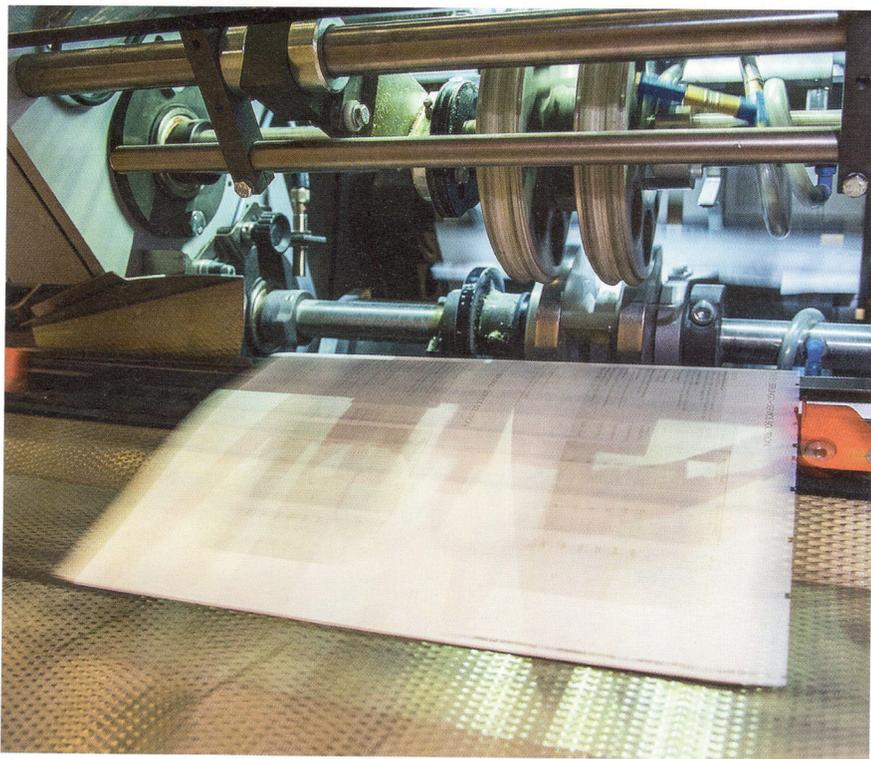
Komfortable Bedienung: Falzbogenanleger in ergonomischer Höhe erlauben beim HSB 13.000 schonende Bogenverarbeitung und verlängerte Beschickungszeiten.
